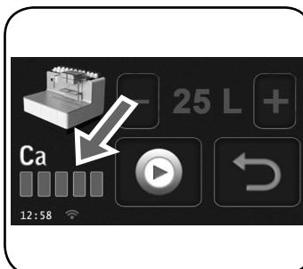
Weergave van 5 rode streepjes: er dient een ontkalkingscyclus te worden uitgevoerd.
