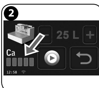
Wanneer het ingestelde aantal liter verstrek is, geven de 5 rode streepjes aan dat het nodig is om de ontkalking uit te voeren.
