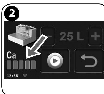
Après la distribution des litres sélectionnés, 5 barres rouges signalent qu'il est nécessaire d'effectuer le détartrage.
