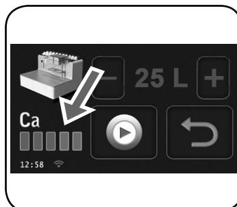
Weergave van 3 rode streepjes: de machine werkt normaal, maar de ontkalkingscyclus kan reeds worden uitgevoerd.
