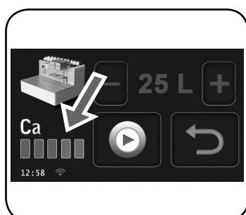
Affichage de 3 barres rouges : la machine fonctionne régulièrement, mais il est déjà possible de lancer le cycle de détartrage.
