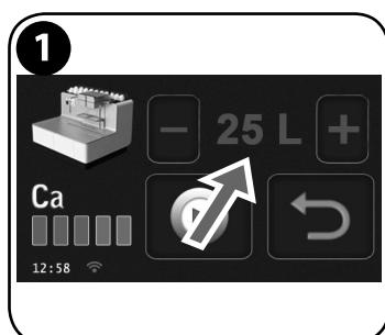
La machine signale combien de litres d'eau à utiliser pour la distribution de café avant qu'elle ne demande un cycle de détartrage.
