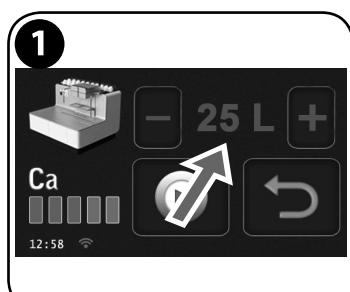
La máquina indica cuántos litros de agua pueden utilizarse para el suministro de café antes de que sea necesario realizar un ciclo de descalcificación.
