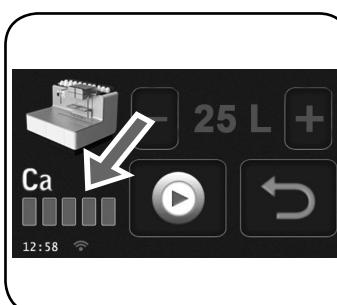
Affichage de 5 barres rouges : il est nécessaire de lancer le cycle de détartrage.
